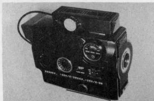
富士・ZC-1000 カメラ・ボディ外観 ボディ右側にCマウント・レンズ取付部分、 カメラ上部にインターバル・タイマー取付。
