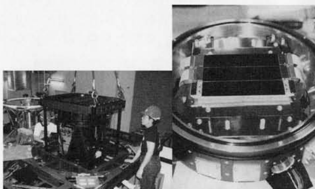
図3 すばる主焦点カメラと、それに使われているCCDチップ (国立天文台 提供)
