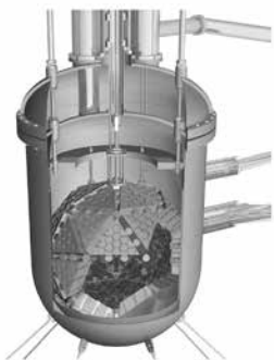
図6: XMASS測定器。液体キセノンを使い、ダークマターがキセノンと衝突したときに発する光を捉えます。放射線不純物の少ない無酸素銅と呼ばれる特殊な銅が容器の素材です。
