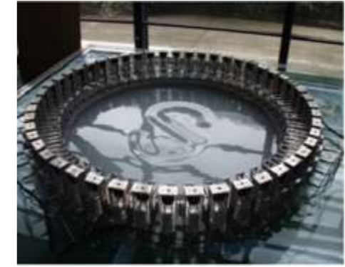
波で水面に文字や図形を描く水槽イメージ 直径1.6m×深さ0.25m
