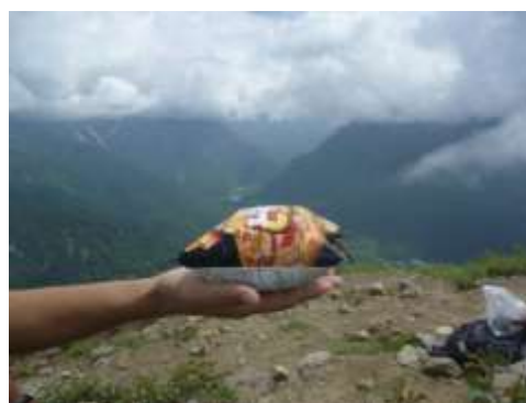
図. 高山の気圧実験装置イメージ 高山では菓子袋が膨らむ。
