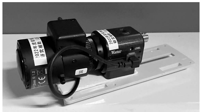
図2 TAMRON社製のレンズを付けたWAT-902H-ULTIMATE。
