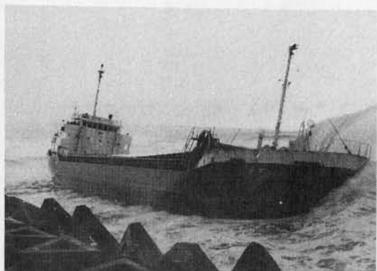
図3. 寄り回り波で護岸堤に押し流される 小型貨物船（伏木港）
