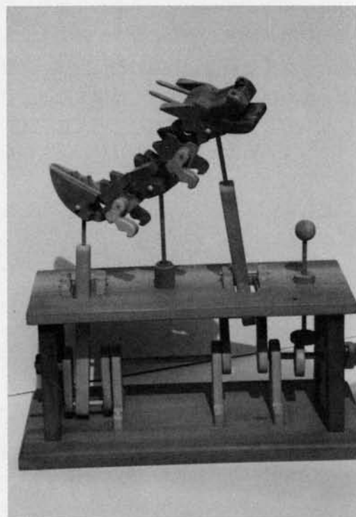
図5 木のからくり「昇竜」 ハンドルを回すと龍の体がくねくねと動きます。クランクを2つ使っています。
