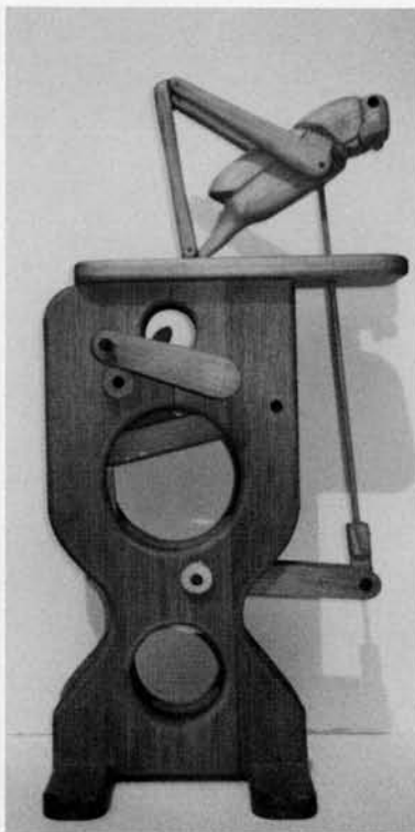
図6 木のからくり「バットン」 リンク機構を使ってバットを動かします。
