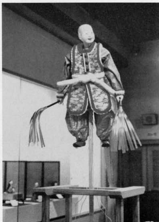
図4 山車からくりの采振り人形 ヒモを引くことで采配を持っている手や足が動きます。
