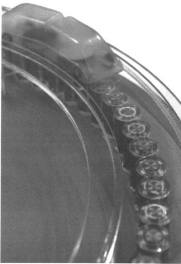
ように切り替えていけば、N極S極の横移動につられて磁石が進んでいきます。
