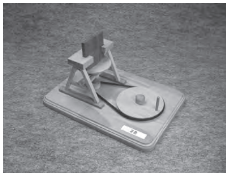
図 11 凹面鏡製造装置（砥石固定型）模型
