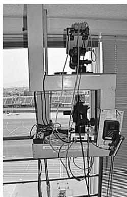
図 14 ゴールを見下ろす写真判定装置のスリットカメラ
