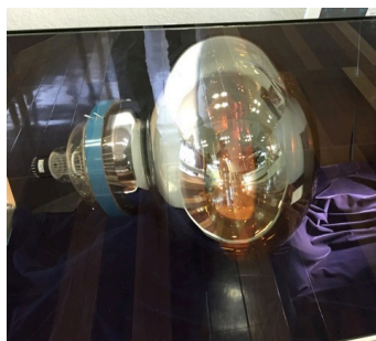
写真2 展示中の光センサー (光電子増倍管) 直径50cm
