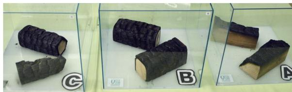
図18. 炭化した木材の断面
