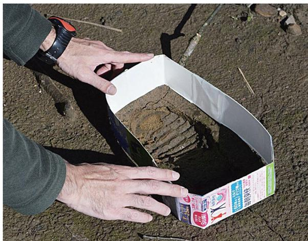
図7. テープで固定したクリアファイルや牛乳パックで、足跡より一回り大きい型枠を作り、足跡を囲むように地面に差し込む。<sup>あしあと</sup> <sup>かたわく</sup> <sup>あしあと</sup>
