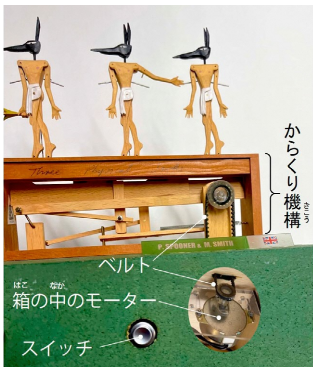
図2. スイッチを押すと、中のモーターが動き、ベルトを回す。作品は「アヌビスのフィットネスクラブ」。
