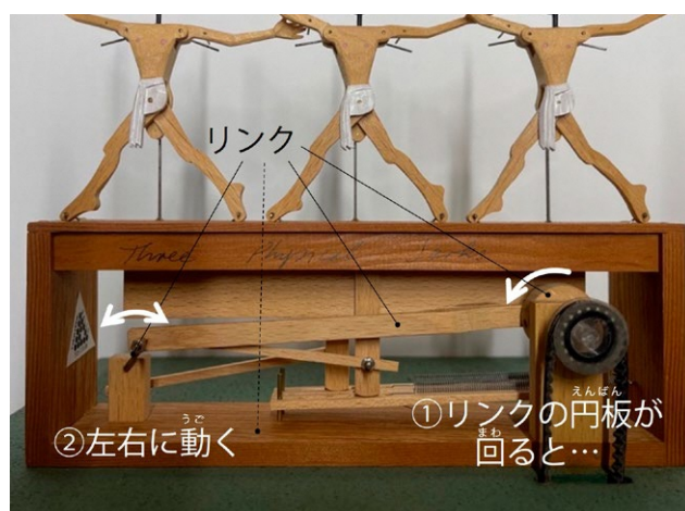
図15. リンク機構が使われている様子(作品は「アヌビスのフィットネス・クラブ」).
