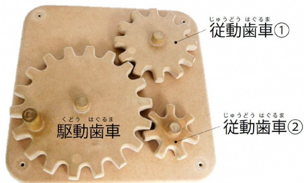
図6. 一つの駆動歯車に二つの従動歯車が組み合わされ、力が二つの歯車に伝わる。
